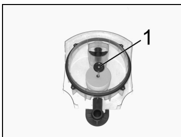
Desenroscar el flotador (1)
